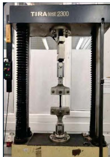
Рис. 6. Випробування TIRA 2300 електромеханічна випробувальна машина використовувалася з фіксованою конфігурацією зразків для експериментів
