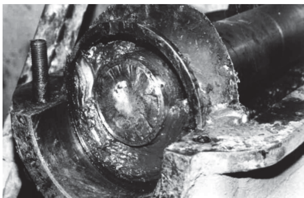
Рис. 1. Характер руйнування вала підвінцевої шестерні кульового вуглерозмелювального млина Ш-12 [18]
