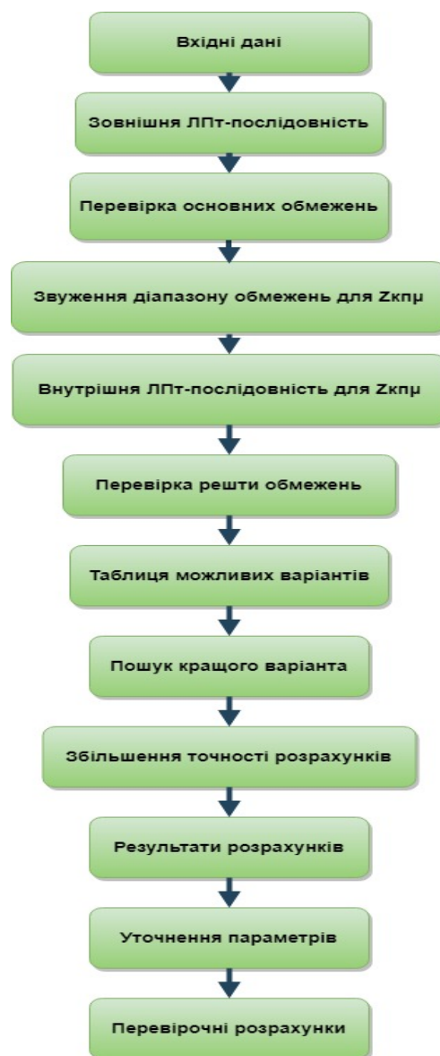
Рис. 2. Схема алгоритму оптимального проектування трансмісії транспортера-тягача МТ-ЛБ.
