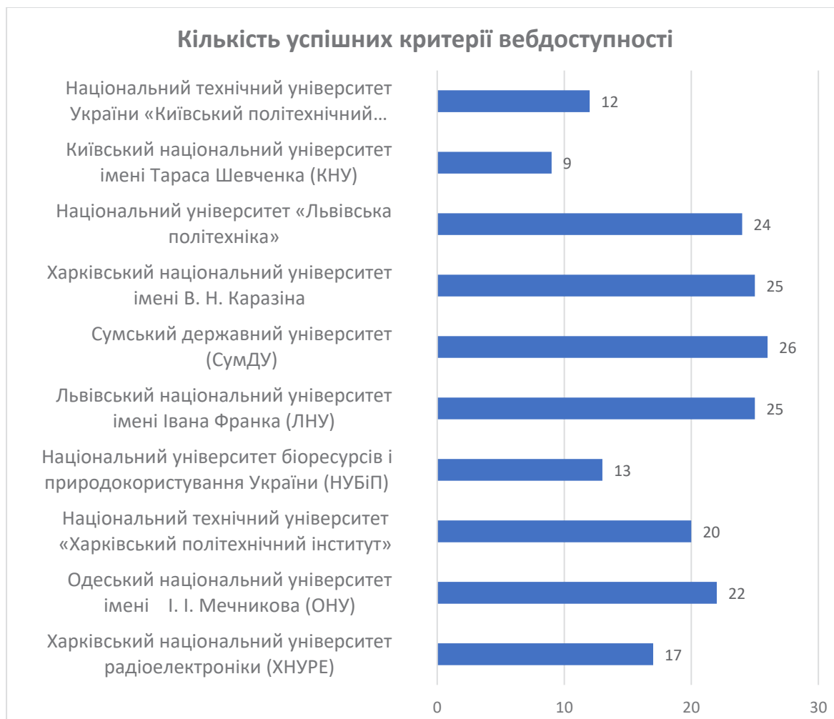
Рис. 5. Результат тестування вебдоступності сайтів навчальних закладів України інструментом QualWeb відповідно до стандарту WCAG 2.1
