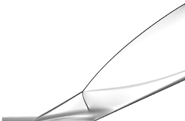
Рис. 9. Чисельна шлірен-фотографія для стрілоподібного кута стиснення за \lambda = 60^\circ , \alpha = 24^\circ , з використанням конічних рівнянь Нав'є – Стокса за \alpha = 20^\circ
