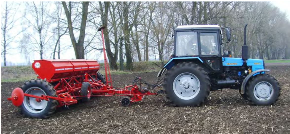
Рис. 20. Інформаційно-технічна система локального оперативного моніторингу агробіологічного стану ґрунтового середовища сільськогосподарських угідь конструкції Олександра Броварця на машинно-тракторному агрегаті під час виконання технологічної операції.
