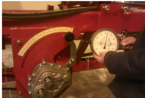
Рис. 12. Вимір зусилля переміщення важеля варіатора для зміни норми внесення технологічного матеріалу інформаційно-технічної системи локального оперативного моніторингу агробіологічного стану сільськогосподарських угідь
