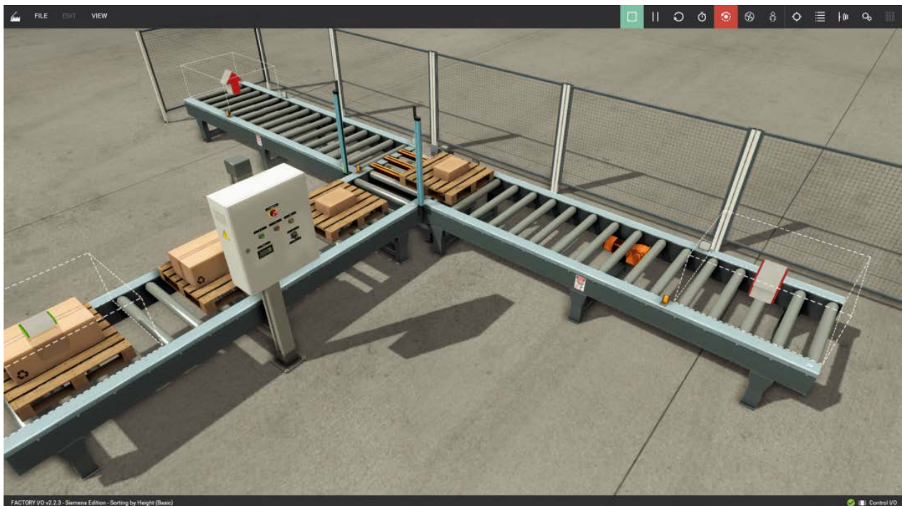
Рис. 1. Вигляд сортувальної станції у програмі Factory I/O.
