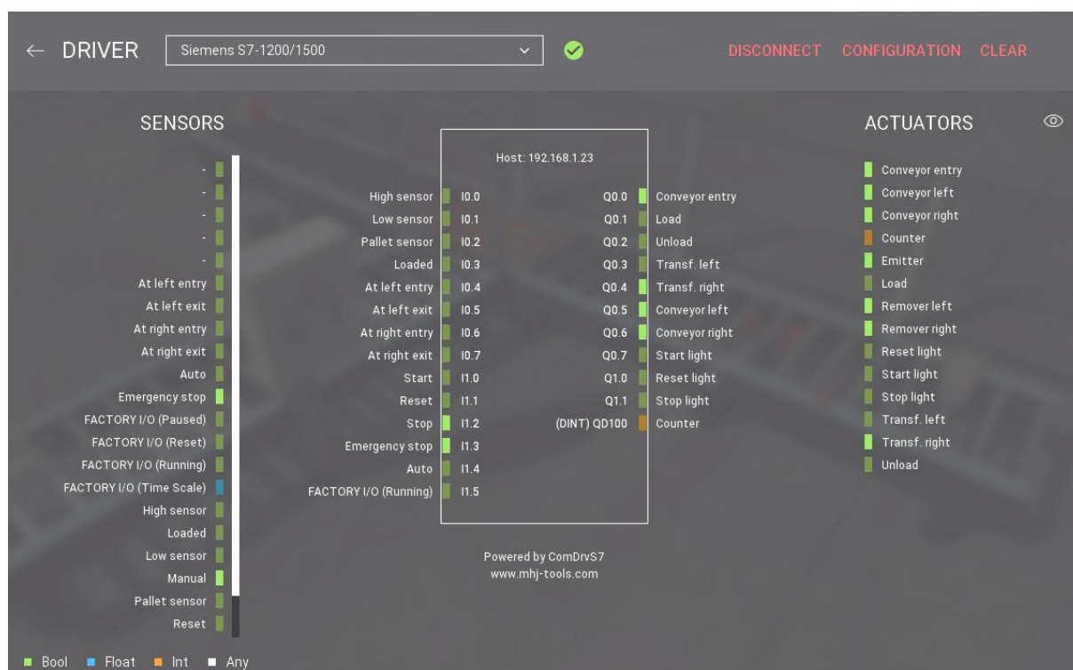
Рис. 4. Контролер Siemens S7-1200 у проекті Factory I/O.
