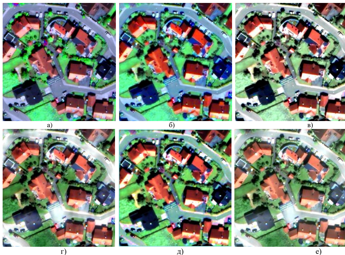
Рис. 3 Фрагменти зображень методами: а) «Brovey»; б) HPF; в) GHS; г) HCT; д) вейвлет-перетворення; е) HSV-HCT.
