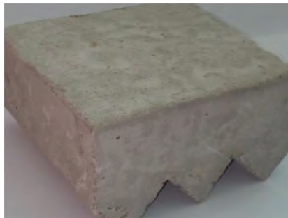
Рис. 3. Експериментальний зразок плити з трьома ребристими призматичними елементами в нижній основі
