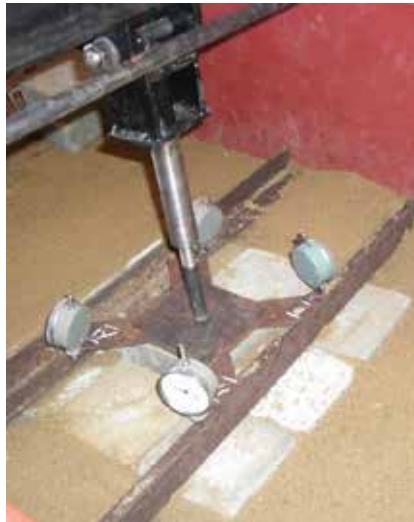
Рис. 5. Дослідження покриття з ФЕМ у лабораторних умовах
