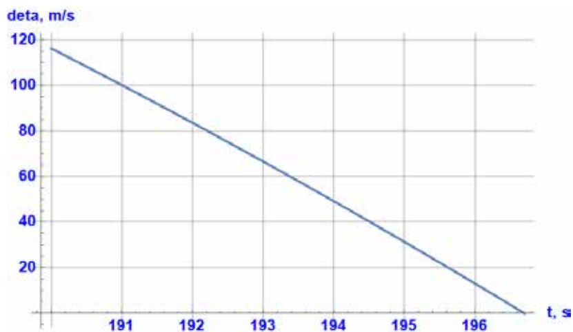
Рис. 11. Графік залежності від часу фазової швидкості зображувальної точки стану розрахункової схеми механічної підсистеми магнітолевітуючого поїзда – режим екстреного гальмування
