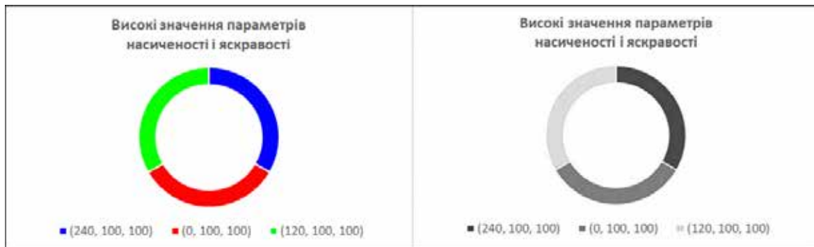
Рис. 1. Параметри кольорів, які не порушують доступність контенту для людини з дальтонізмом типу «ахромато́пія»
