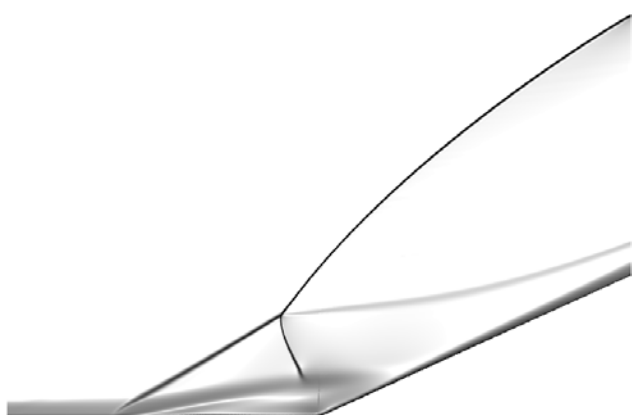
Рис. 9. Чисельна шлірен-фотографія для стрілоподібного кута стиснення за \lambda = 60^\circ , \alpha = 24^\circ , з використанням кінцевих рівнянь Нав'є – Стокса за \alpha = 20^\circ
