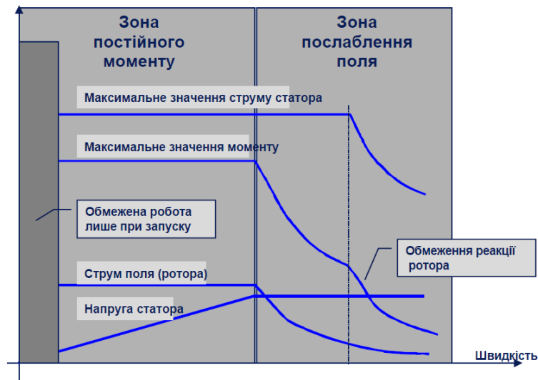
Рис. 4. Характеристики меж експлуатації для синхронного двигуна з перетворювачем інверторного типу з джерелом струму
