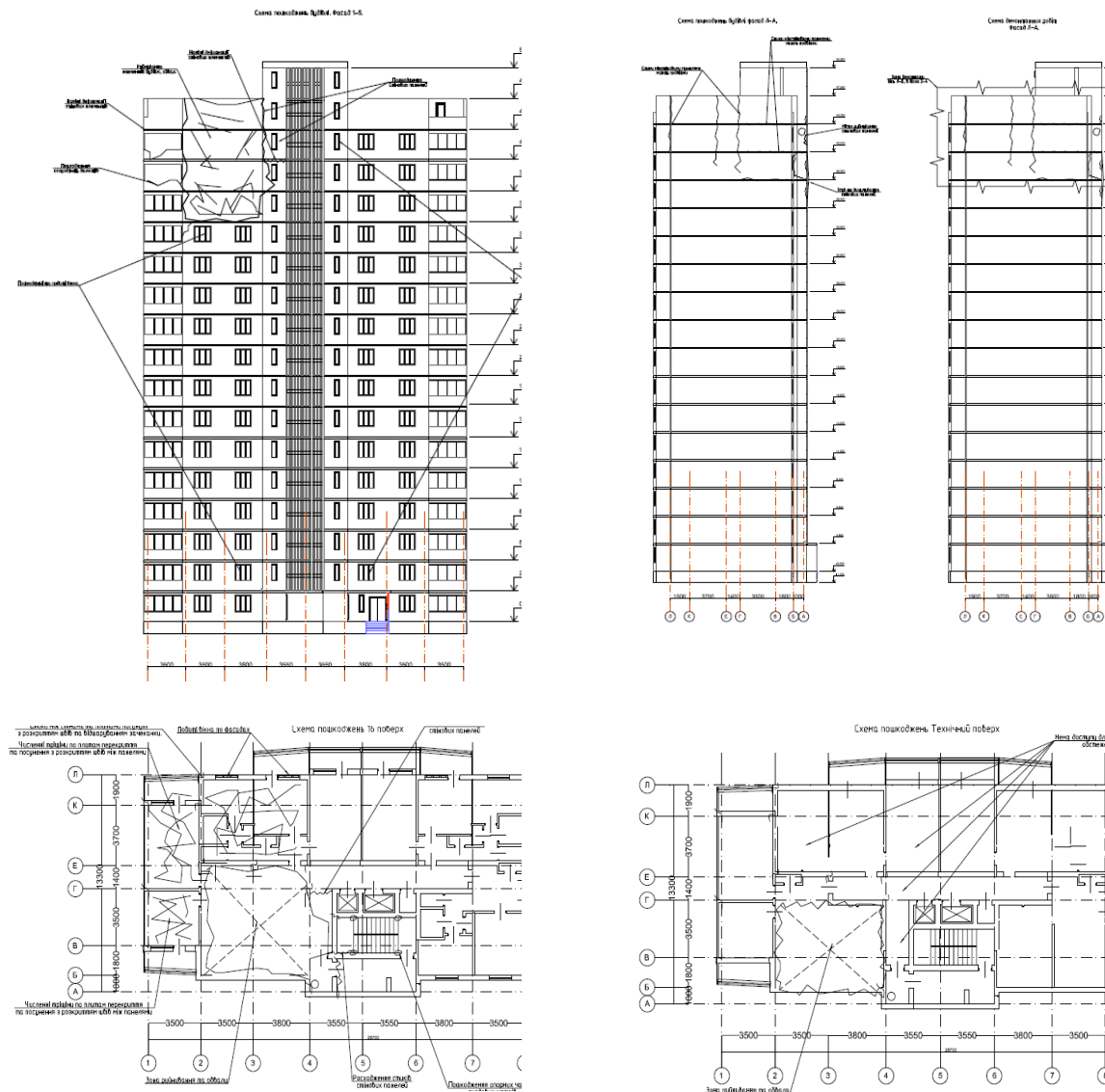
Рис. 4. Схеми деформацій та руйнувань будівлі, постраждалої внаслідок бойових дій
