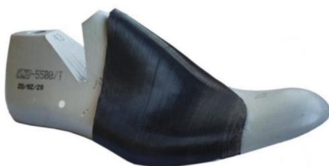
Рис. 3. Вигляд модифікованої колодки з накладкою
