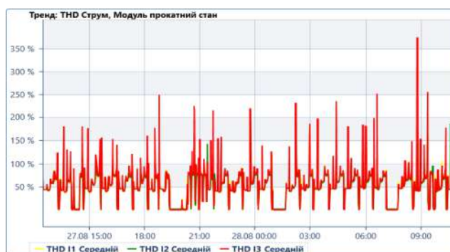
Рис. 3. Реєстрограма зміни сумарного коефіцієнта гармонічних спотворень струмів
