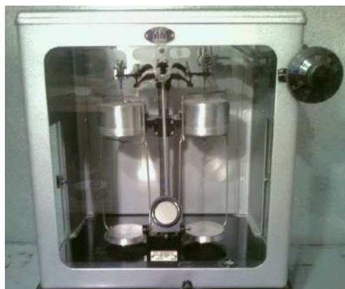
Рис. 7. Аналітичні ваги типу АДВ-200М
