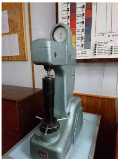
Рис. 4. Прилад для вимірювання твердості HRC по Роквелу
