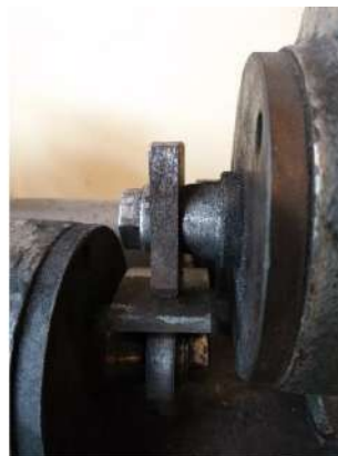
Рис. 6. Машина тертя МІ – 1М (машина Амслера)
