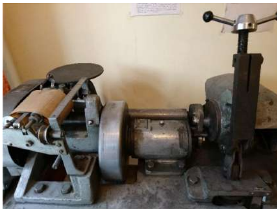
Рис. 6. Машина тертя МІ – 1М (машина Амслера)
