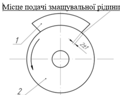
Рис. 8. Схема випробувань: 1 – зразок; 2 – контрзразок
