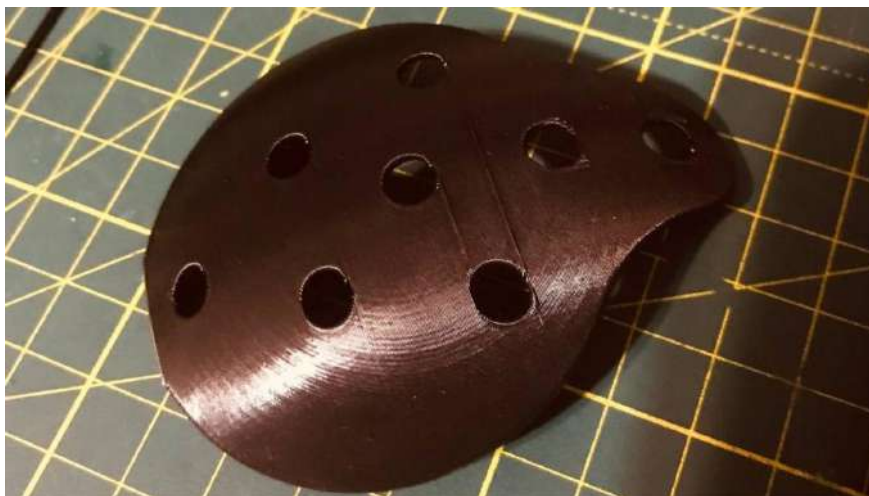
Рис. 3. Видима шаруватість поверхні друківаного виробу
