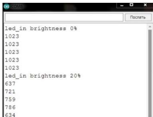
Рис. 5. Представлення вихідної напруги фоторезистора
