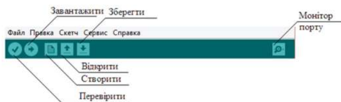
Рис. 3. Вигляд панелі інструментів середовища Arduino IDE
