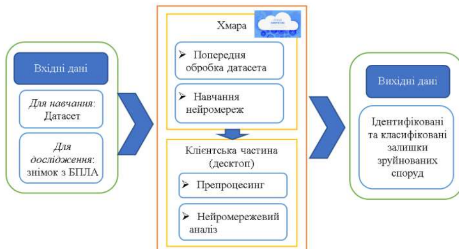
Рис. 1. Інформаційна хмарна технологія неймережевого аналізу зруйнованих споруд
