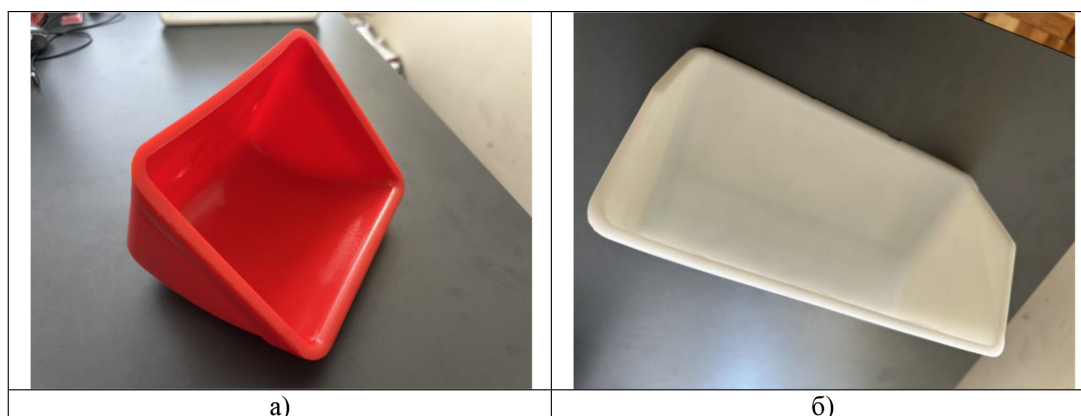
Рис. 3. Загальний вигляд ковшів, що використовуються в зернових вертикально розташованих норіях (в складі елеваторного обладнання) з криволінійною поверхнею (а) та ламаною плоскою поверхнею (б) внутрішньої нижньої стінки відносно проходження зерна при відцентровому розвантаженні (фото авторів)
