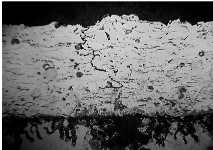
Рис. 2. Мікроструктура плазмового покриття з порошку ПС-12НВК-01
