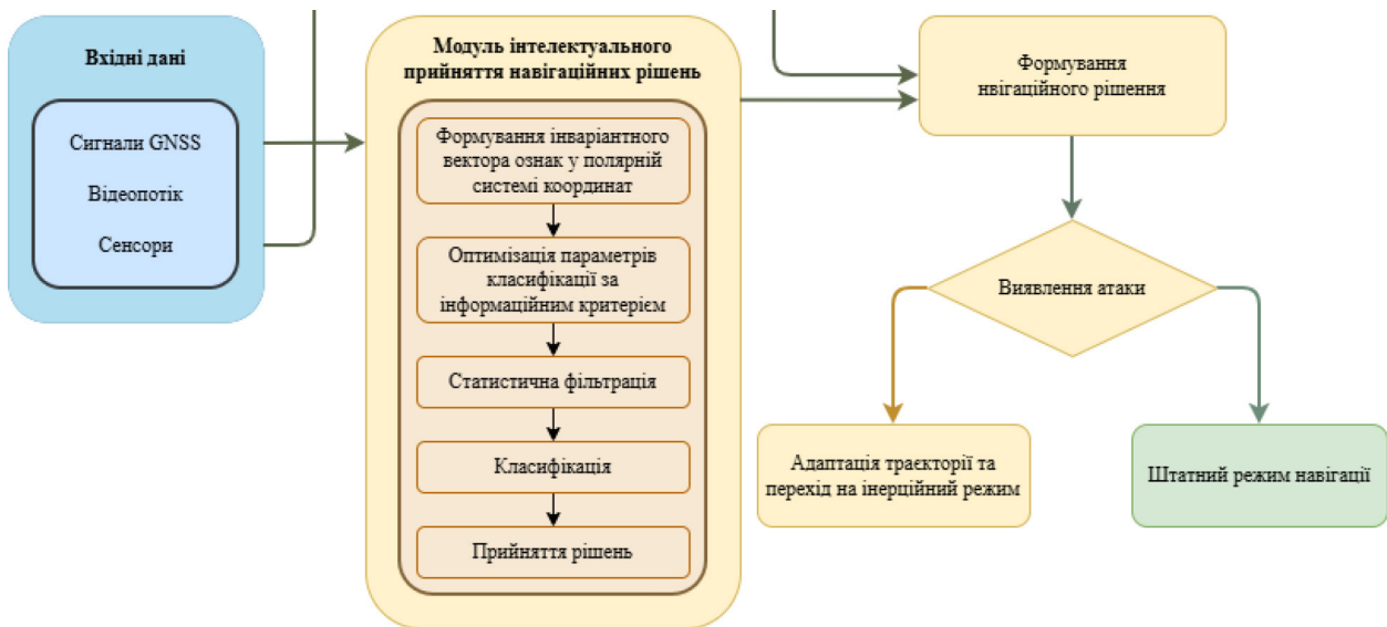
Рис. 2. Концептуальна схема гібридної системи захисту автономного БПЛА
