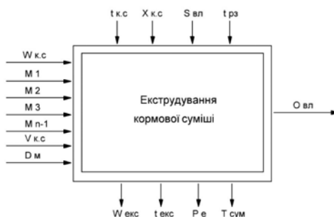
Рис. 4. Схема впливу різноманітних факторів на процес екструдування
