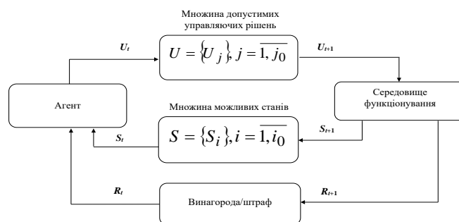
Рис. 6. Блок-схема формування управляючих рішень інтелектуальним агентом на основі алгоритму Q-навчання з підкріпленням
