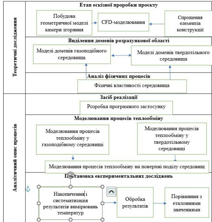
Рис. 3. Алгоритм обміну розрахунковими і експериментальними даними температурних параметрів у камерах згоряння газотурбінних двигунів
