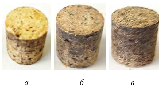
Рис. 2. Зразки пелет (діаметр 16 мм) з ОСВ-2 та тирси, вміст якої складає, %: a – 90; б – 70; в – 50, виготовлених при тиску 130,5 МПа
