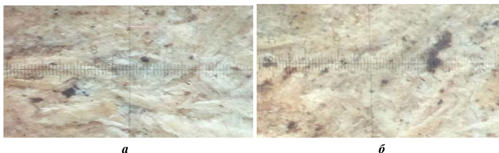
Рис. 3. Фото структури поверхні зразків композитних пелет: a – зовнішня поверхня зразка, виготовленого з тирси і ОСВ-1 з кінцевим тиском 130,5 МПа; б – те ж з кінцевим тиском 217,5 МПа
