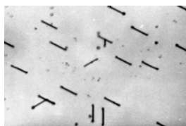
Рис. 1. Мікрофотографія поверхні епітаксіальної структури після термічного окислення і проведення селективного травлення. Збільшення 535 x
