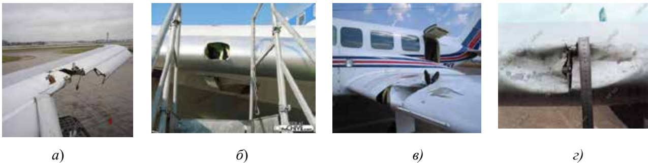
Рис. 3. Повреждения внешних обводов самолетов инородными формированиями: а) – обрыв; б) – пробій; в), г) – вм'ятина з розривом
