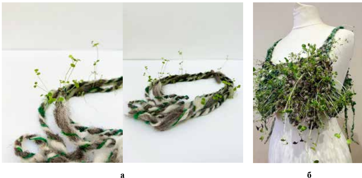
Рис. 5. Пряжа з інтегрованим в структуру насінням (а) та трикотажний топ, виготовлений з цієї пряжі (б) [1]
