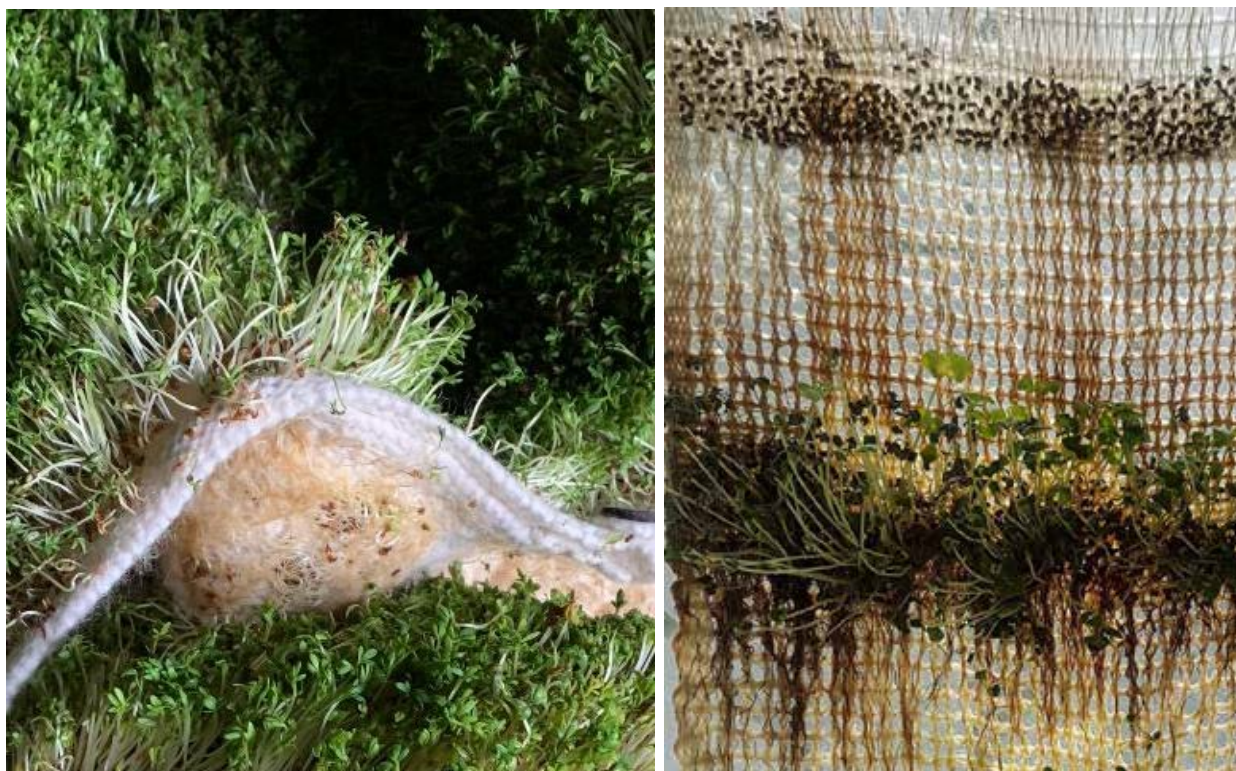
Рис. 2. Пророщення насіння на готовому текстильному полотні: а – трикотажне полотно; б – тканина
