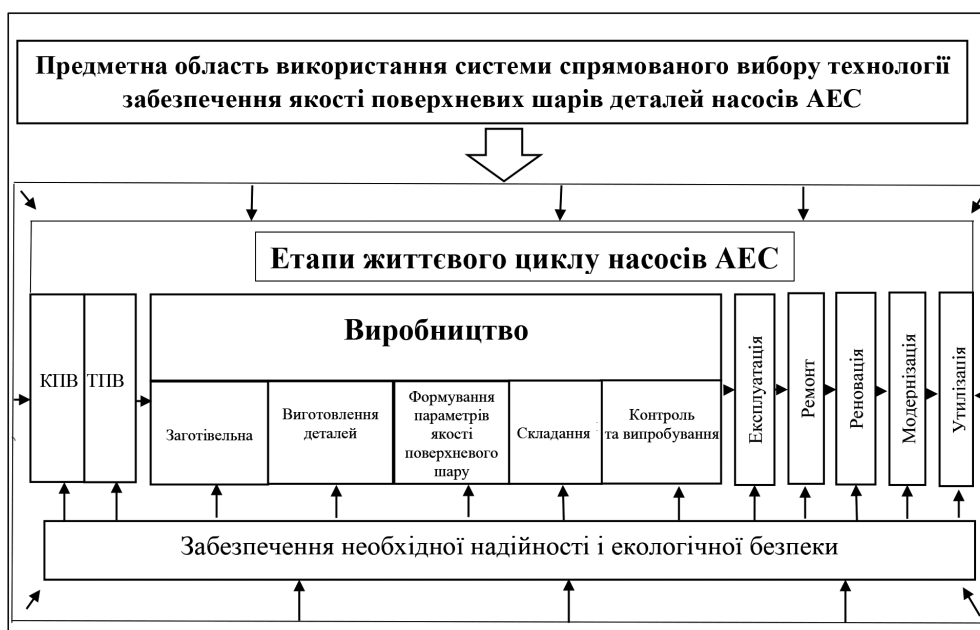
Рис. 1. Використання системи спрямованого вибору технології забезпечення необхідної якості поверхневих шарів деталей насосів АЕС на різних етапах життєвого циклу
