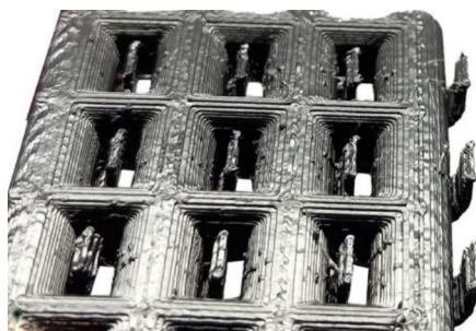
Рис. 6. Пелюсткова структура, виготовлена методами 3D-прототипування
