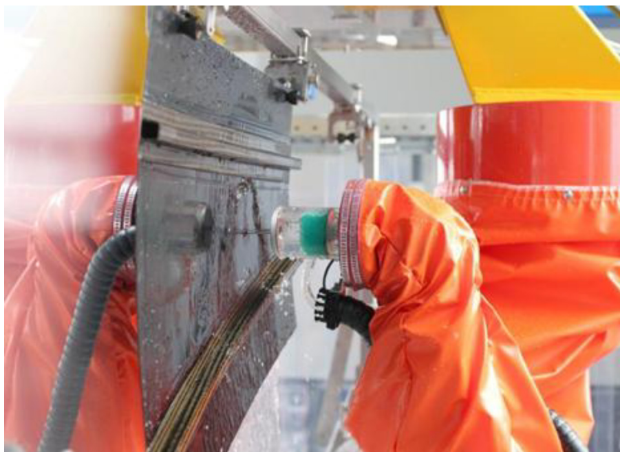
Рис. 6. Роботизована клітина з синхронізованими маніпуляторами для неруйнівного ультразвукового контролю складнопрофільних деталей [9]
