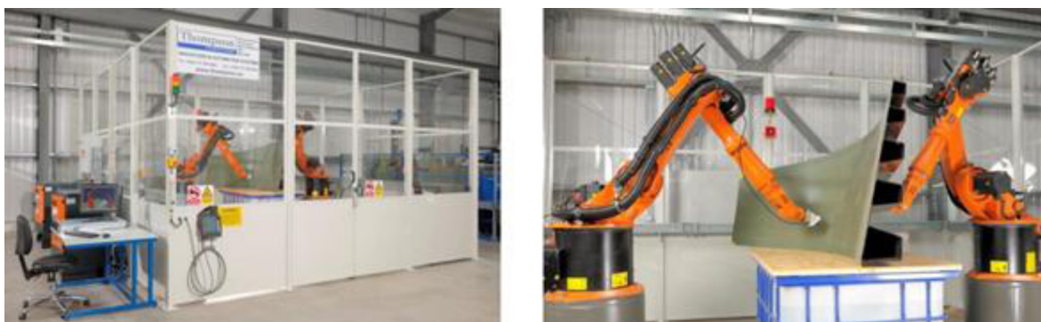
Рис. 1. Інтелектуальна система контролю якості обробки складнопрофільних деталей із використанням роботизованої камери IntACom [9]
