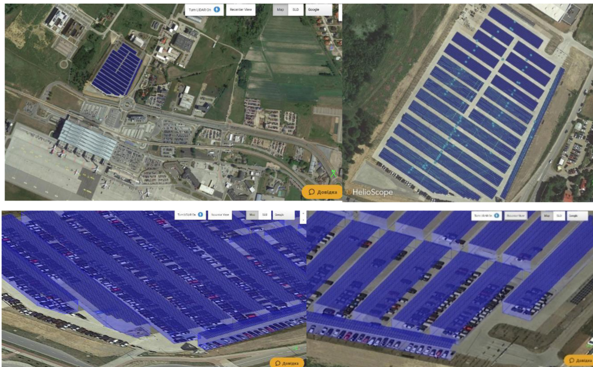
Рис. 3. Звіт з моделювання дизайну мережевої фотоелектричної станції для автомобільної стоянки, візуалізовано в HelioScore [6]
