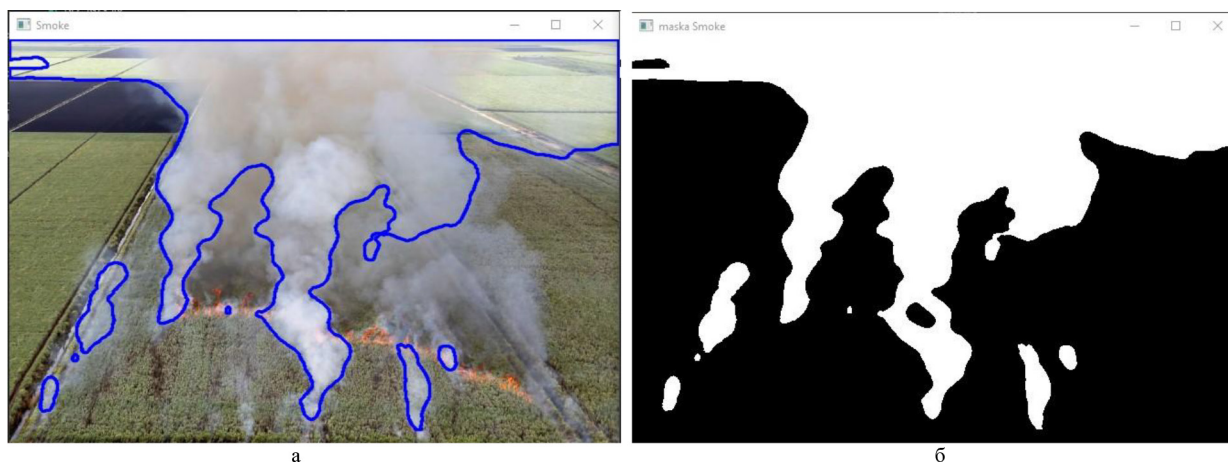
Рис. 1. Приклад роботи розробленого алгоритму із виявлення диму: а – розпізнана область диму; б – маска зображення диму
