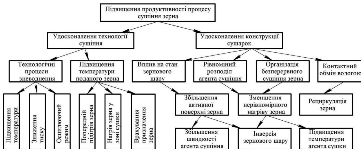
Рис. 1. Класифікація способів підвищення продуктивності процесу сушіння зерна
