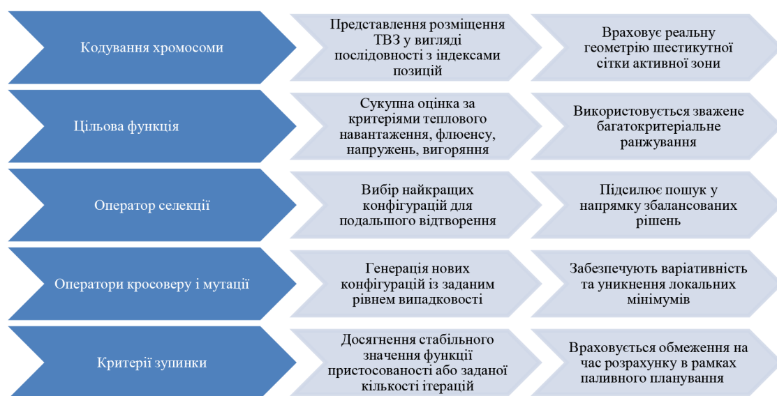
Рис. 1. Структура дискретної моделі оптимального розміщення ТВЗ на основі генетичних алгоритмів
