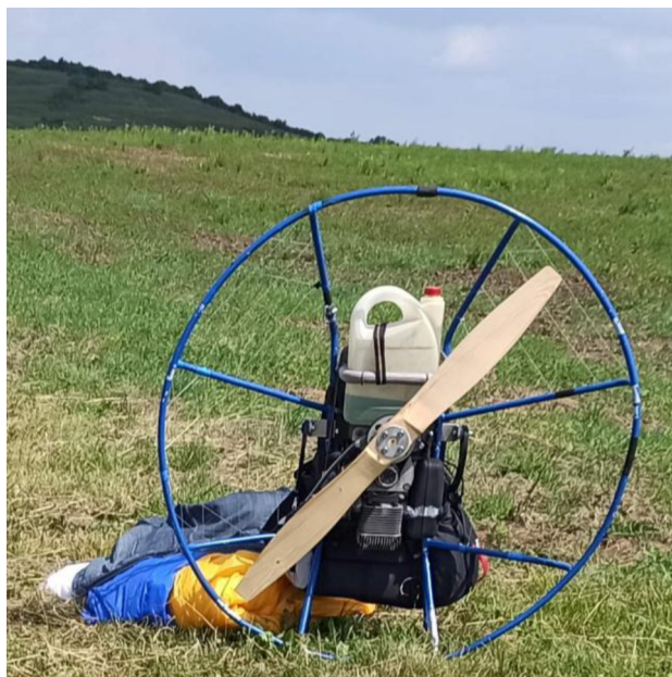
Рис. 3. Зовнішній вигляд парамоторної установки з повітряним гвинтом 125 × 57
