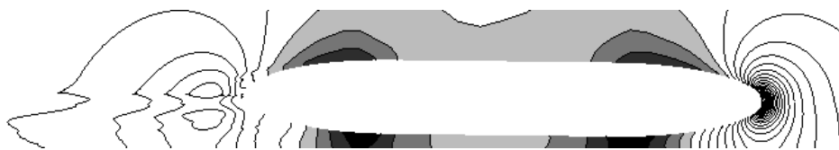
Рис. 2. Ізобари в площині XOY розрахункової області навколо корпусу швидкісного транспортного апарата
