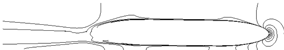
Рис. 3. Ізолінії завихренності у площині XOY розрахункової області навколо корпусу швидкісного транспортного апарата
