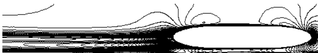
Рис. 5. Ізомахи площині XOY розрахункової області навколо корпусу швидкісного транспортного апарата
