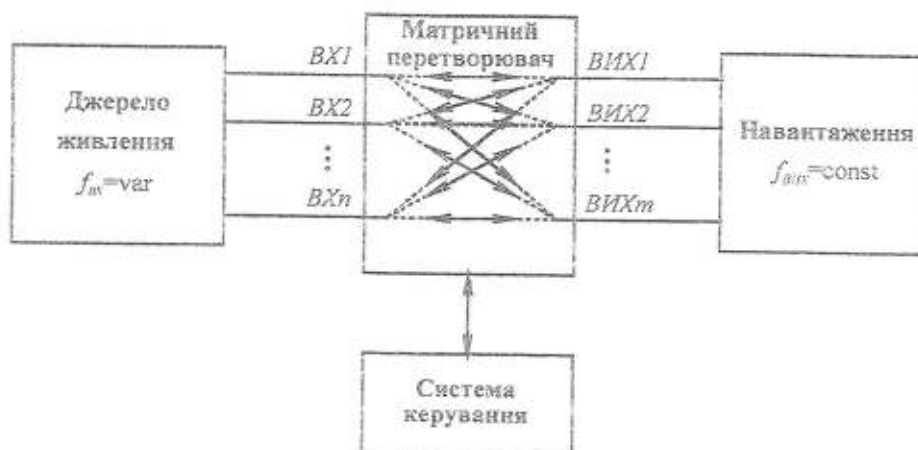
Рис. 1. Структурна схема узагальненого перетворювача частоти з n -фазами на вході і m -фазами на виході
