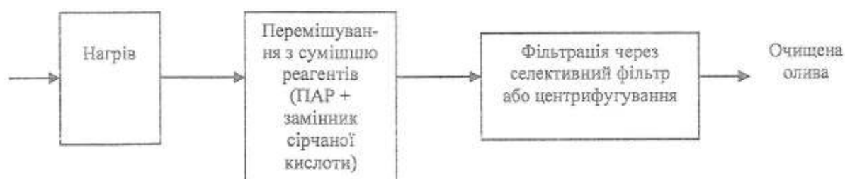
Рис. 3. Схема очистки відпрацьованої моторної оливи
