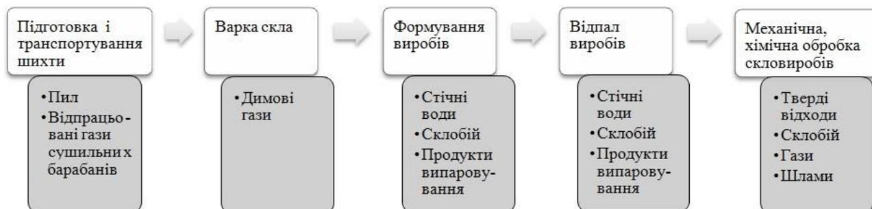
Рис. 1. Викид шкідливих речовин на стадіях технологічного процесу виготовлення сортового посуду
