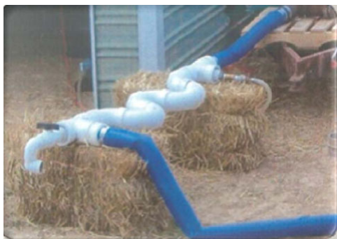
Рис. 8. Вбудована система змішування суспензії із зворотною трубою (1) та пристрій розвідної системи напірних труб (2)
