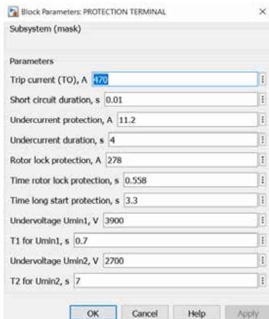
Рис. 4. Приклад введених параметрів блоку «Protection terminal»
