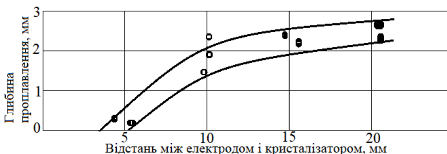
Рис. 4. Вплив зазору між електродом і кристалізатором на глибину проплавлення основного металу
