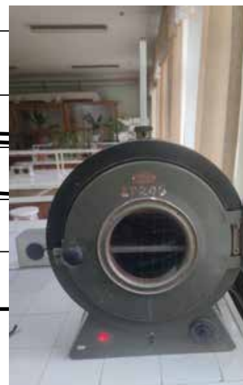
Рис. 5. Експериментальні термоциклічні навантаження на втому матеріалу пневматичної шини в залежності від часу а) – діаграма; б) – обладнання шафа сушильна ШС-3
