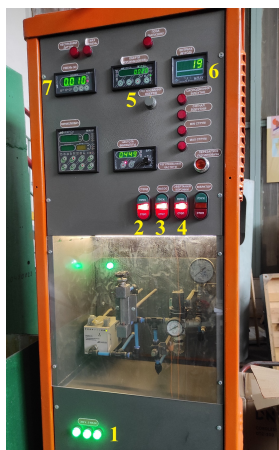
Рис. 2. Пост керування експериментальним стендом: 1 – світлова індикація про подачу напруги до силового кола; 2, 3, 4 – кнопкові пости зі світловою індикацією про вмикання/роботу/вимикання відповідно стенду, насосу, обертання корзини; 5 – регулювання обертів корзини; 6 – показник витрат рідини; 7 – рівень стовпа рідини
