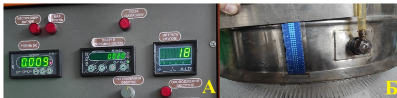
Рис. 4. Контрольовані параметри системи: А – витрата рідини \text{м}^3/\text{год} ; Б – рівень стовпа рідини в грануляційній башті
