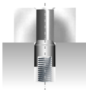
Рис. 5. Орієнтування втулки по внутрішньому діаметру за допомогою підпружиненого конуса
