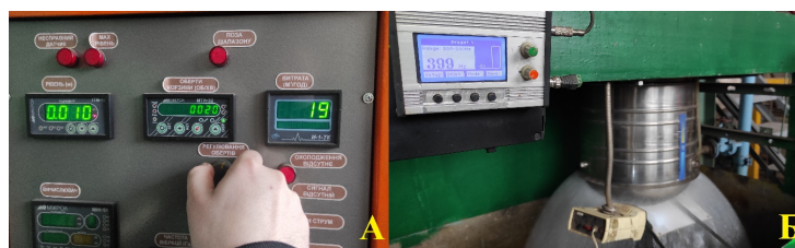
Рис. 3. Регулювання параметрів експериментальної установки: А – обертання корзини гранулятора, об/хв; Б – частота вібрацій, Гц
