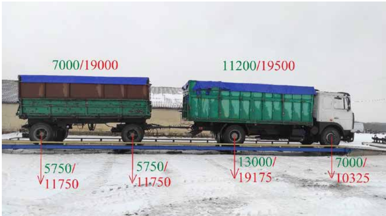
Рис. 5. Розподіл маси по осям. Зел. – допустима маса, черв. – фактична маса
