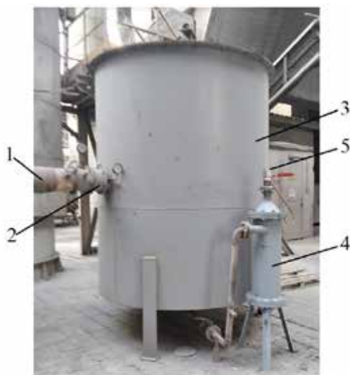
Рис. 7. Установа для очищення димових газів цементного виробництва від водяної пари, пилу та механічних домішок
