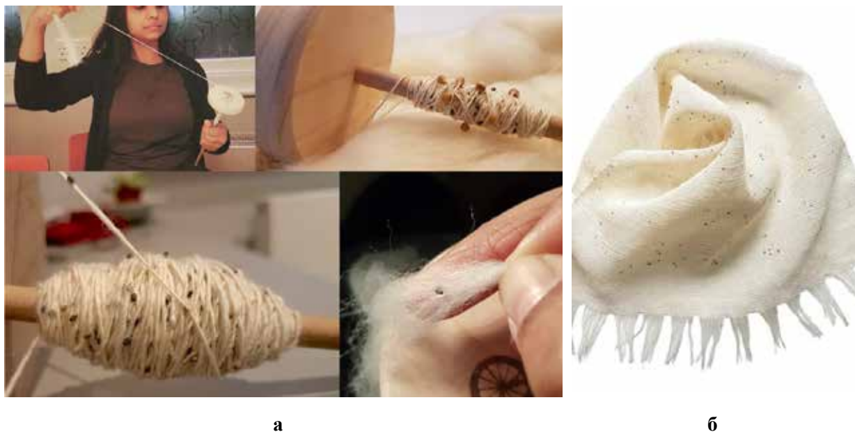
Рис. 4. Ілюстрація процесу інтегрування насіння в пряжу під час прядіння (а) та тканий виріб, виготовлений з цієї пряжі (б) [6]
