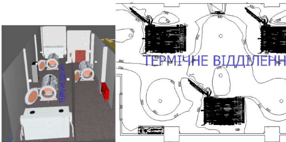
Рис. 4. Вигляд приміщень та ізолінії освітленості термічного відділення зварювального цеху, отримані моделюванням в DIALux Evo [4]
