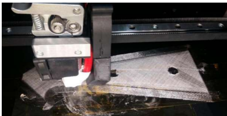
Рис. 2. Друк оснащення для аерокосмічного виробництва
