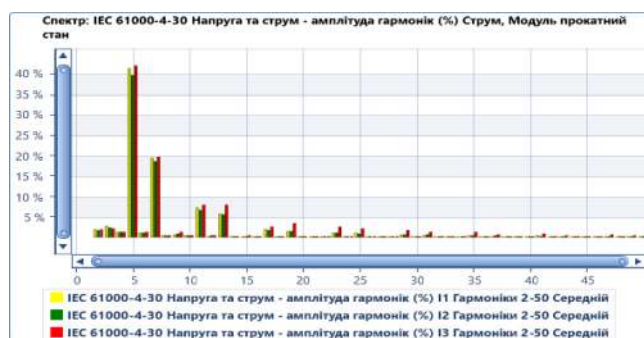
Рис. 4. Спектральний аналіз (середні значення амплітуд) гармонійних складових струмів
