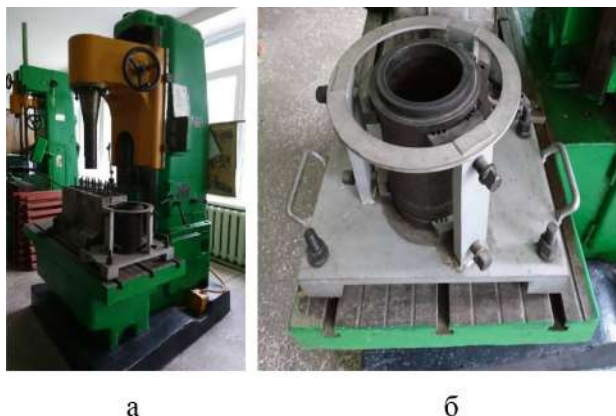
Рис. 2. Технологічне обладнання: а) вертикально-розточувальний верстат 2Е78П; б) пристосування для центрування гільз гідроциліндрів на станині верстату
