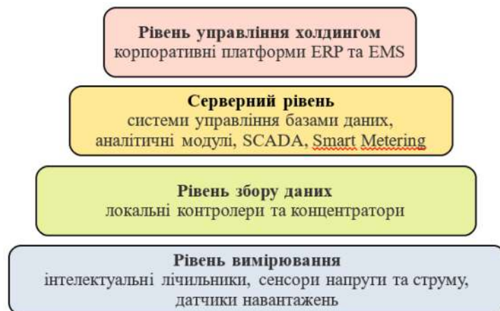
Рис. 1. Типова архітектура АСКОЕ по рівнях
