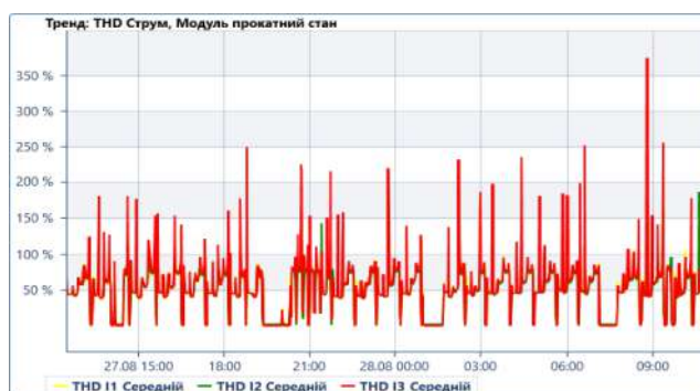
Рис. 3. Реєстрограма зміни сумарного коефіцієнта гармонічних спотворень струмів
