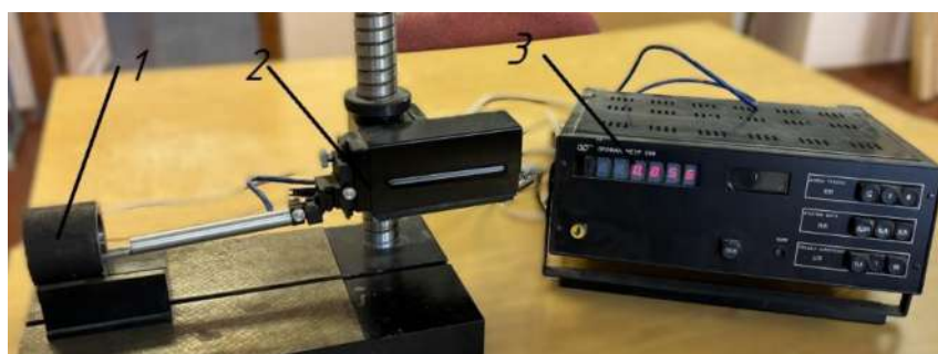
Рис. 5. Фото досліджень: 1 – заготовка; 2 – штатив профілометра; 3 – табло профілометра
