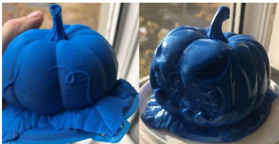
Рис. 5. Результат хімічного згладжування 3-D друкованого виробу
