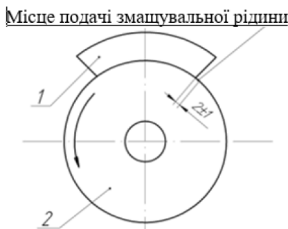
Рис. 8. Схема випробувань: 1 – зразок; 2 – контрзразок
