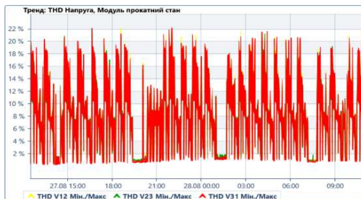
Рис. 1. Реєстрограма зміни сумарного коефіцієнта гармонічних спотворень міжфазних напруг
