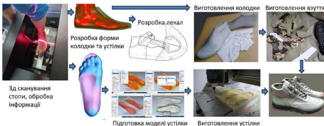
Рис. 4. Етапи виробництва ортопедичного взуття за індивідуальним замовленням
