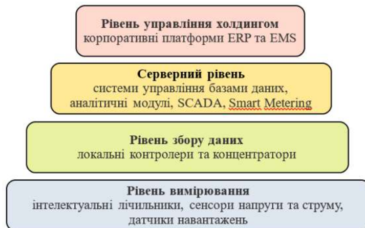
Рис. 1. Типова архітектура АСКОЕ по рівнях
