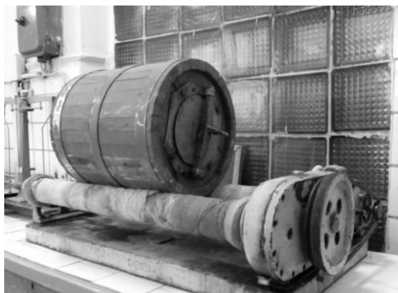
Рис. 1. Лабораторна установка формування шкіряного матеріалу
