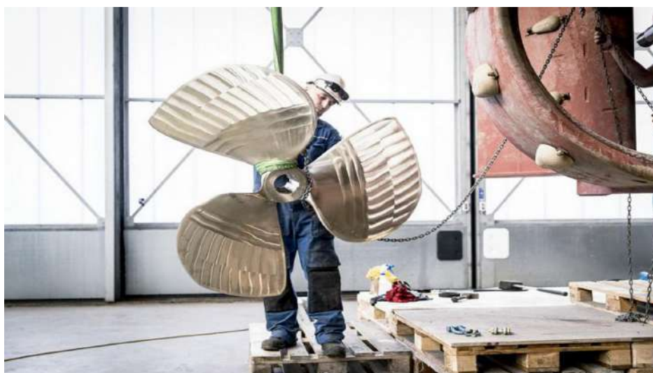
Рис. 1. Перший у світі гребний гвинт, надрукований на 3D-принтері з нікель-алюміній-бронзового сплаву за допомогою дугового зварювання
