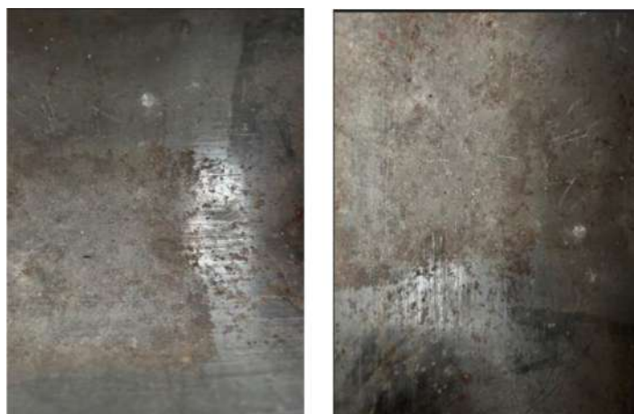
Рис. 1. Фото гідроабразивного та абразивного зношування внутрішньої поверхні гільзи гідроциліндра
