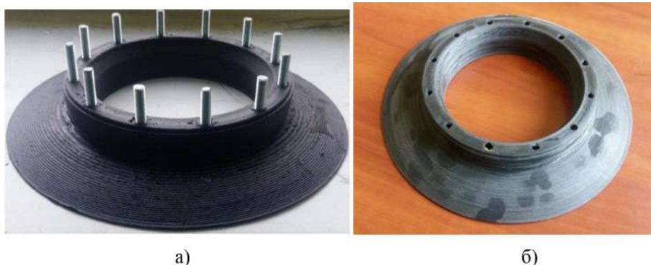
Рис. 4. 3-D друкований виріб: а) до шліфування; б) після механічної обробки
