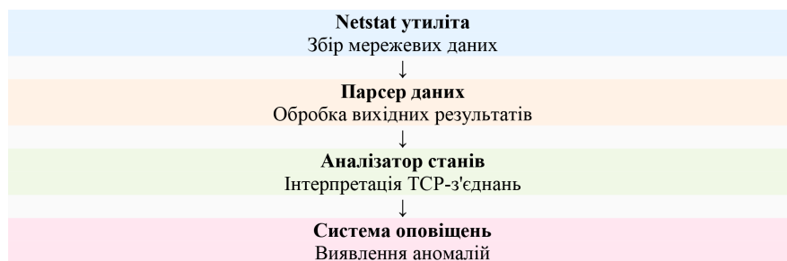
Рис. 1. Архітектура системи моніторингу на базі netstat
