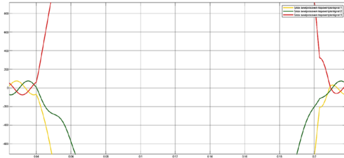
Рис. 4. Осцилограма перехідного процесу струму в режимі КЗ у момент часу 0,04 с [3]
