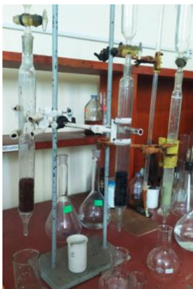
Рис. 2. Світлина лабораторної установки вилучення сполук фосфору з рідких відходів природними алюмосилікатами
