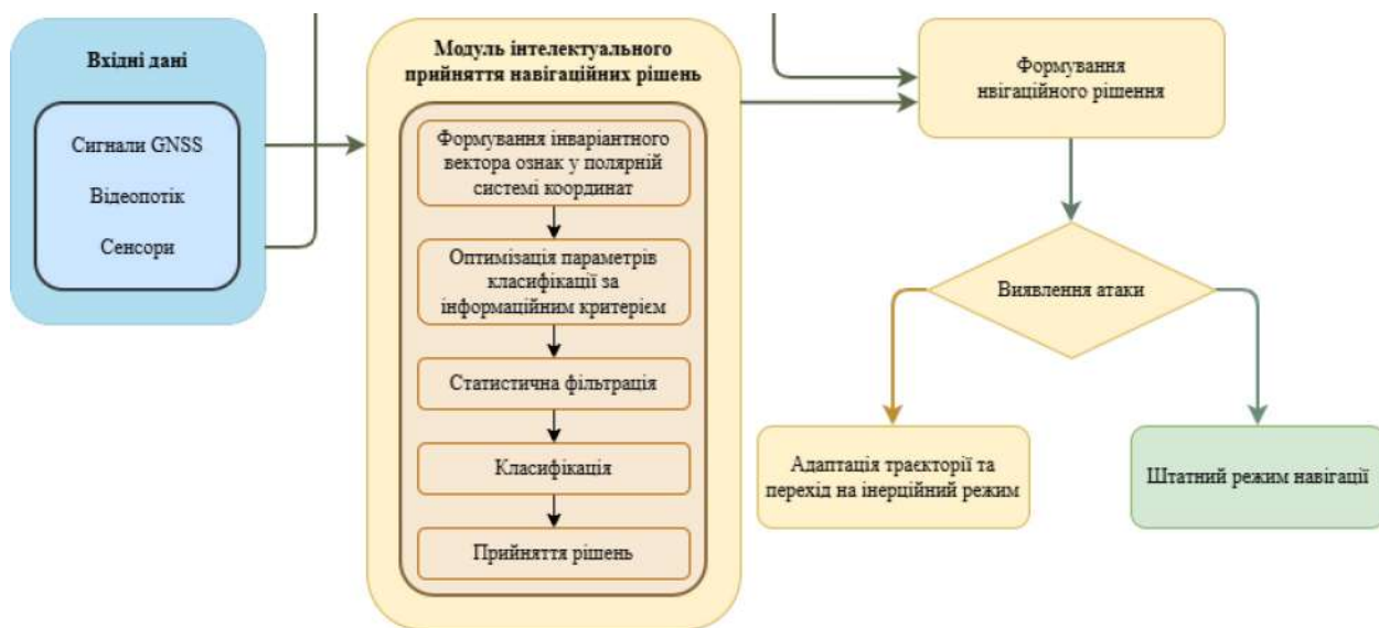
Рис. 2. Концептуальна схема гібридної системи захисту автономного БПЛА
