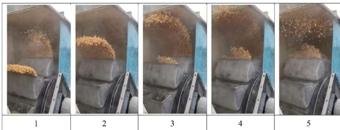
Рис. 2. Фотовідеофіксація динаміки відцентрового розвантаження ковшової норії марки У13-УН при транспортуванні зерна кукурудзи (опрацьовано авторами на основі: https://www.facebook.com/watch/?v=727221748017015 )
