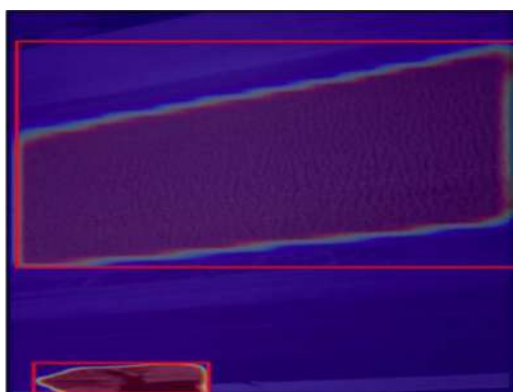
Рис. 5. Виділення дефектів стрічки по контуру їх розташування
